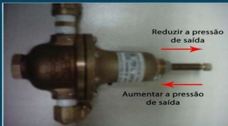
Figura 8 – Ajuste do piloto
